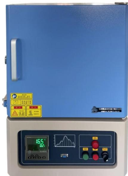
KSL-1800X-A1 是一款高温箱式炉，以硅钼棒为加热元件，采用双层壳体结构和 PID 程序控温，B 型热电偶，炉膛采用高纯氧化铝纤维材料，最高温度能达到 1800 度，可连续工作温度 1750 度，控温精度  $\pm 0.1$  度，该炉具有温场均匀、表面温度低，节能等优点，是高校、科研院所、工矿企业做高温烧结，金属退火、质量检测用的理想产品。
